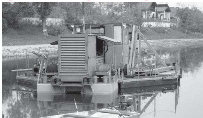
Sací bager dôstojne pláva po jazerách a zbavuje ich sedimentov.
