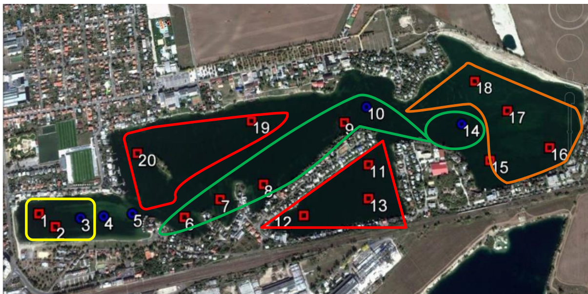
Obr. 2. Mapa nádrže s body odběru (modře - odebrána voda, červeně - odebrána voda i sediment, barevně vyznačené lokality podle druhů a mocnosti sedimentů viz. Závěry a doporučení)
