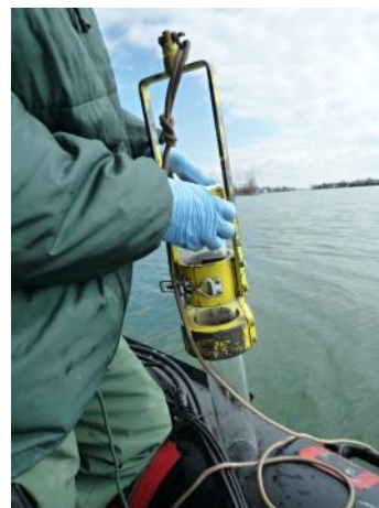
Obr. 7. – 12. Odběr sedimentu na lokalitě 1 a detail rozkládající se biomasy v jeho horní vrstvě
