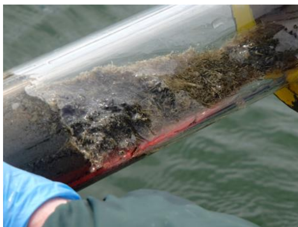
Obr. 7. – 12. Odběr sedimentu na lokalitě 1 a detail rozkládající se biomasy v jeho horní vrstvě
