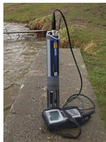
Obr. 3. multiparametrická sonda YSI 6600
